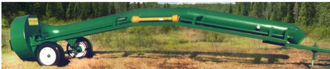
A operação consiste em colocar o reboque na água, colocando um veio de transmissão flexível entre a unidade de alimentação e o veio da bomba e ligar a tubagem ao tubo de descarga com uma braçadeira.
