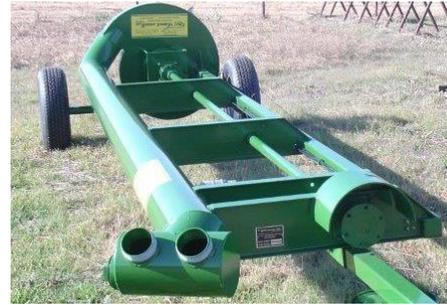
São bombas de aço com tubos de aço altamente resistentes. Corpo da bomba e impulsores são feitos de chapa de aço de 3/8". Fornecem grandes volumes de água com tomada de força usando tractor, motores a gasóleo ou eléctricos. Estão disponíveis em unidades de 540 RPM ou 1000 RPM.
